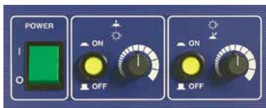
O ajuste de iluminação contínua foi adotado para fornecer iluminação moderada de acordo com a textura da superfície e a cor da peça de trabalho. A intensidade da iluminação varia de fraca a forte e este método também é eficaz para estender a vida útil da lâmpada de halogênio, que é aprimorada pelo uso de um recurso de partida suave para limitar a corrente de pico.
