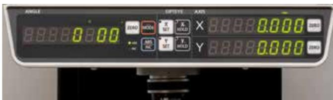
O contador digital (ângulo e eixos XY) incorporado em todos os modelos utiliza como padrão um LED de alta intensidade e um display com caracteres grandes garantindo alta visibilidade, que não é afetada pela luminosidade do ambiente. Além da configuração de zeragem e da mudança de direção, a saída de dados de cada valor do contador pode ser efetuada pela saída RS-232C.
