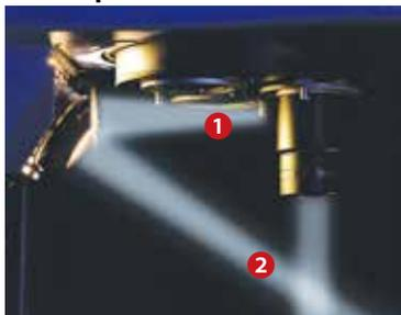
A iluminação refletida é composta por iluminação vertical, que passa pelas lentes de projeção, e iluminação oblíqua, com ângulo variável do emissor de iluminação, como padrão. É eficaz na observação tridimensional com reprodutibilidade de cores aprimorada.
