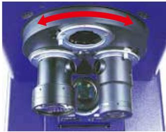
A torre da série **PJ-H30** usa rolamentos de baixa fricção que permitem um movimento rotativo suave e rápido para alterar a ampliação, trazendo diferentes lentes de projeção para o caminho da luz. O corpo da torre usa montagens de baioneta para ajudar na fixação e desprendimento rápido das lentes.
